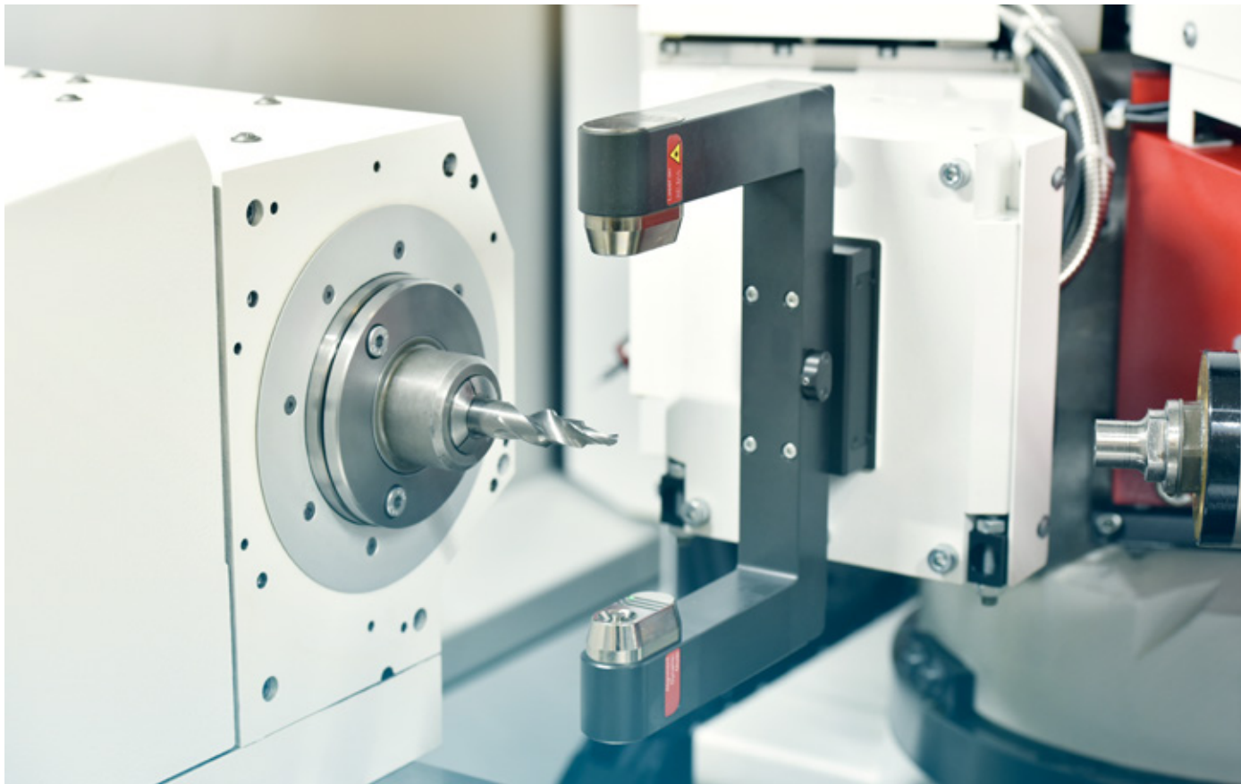
2 Berührungslose Laser-Messung von Präzisionswerkzeugen
